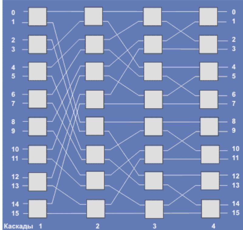
**Источник 2:** Многокаскадные сети основаны на использовании 2x2 перекрестных переключателей - коммутаторов. В таких сетях на одном конце находятся процессоры, на другом - процессоры или другие узлы, а между ними располагаются переключатели. При передаче информации от узла к узлу переключатели устанавливаются таким образом, чтобы обеспечить требуемое соединение. На приведена схема соединения "омега", являющейся сетью с блокировкой, в которой один маршрут передачи данных может заблокировать
